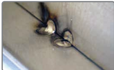
날카로운 로드는 웰딩을 배열하는데 도움이 되고, (왼쪽) 둔탁한 로드는 에너지를 방출 및 웰딩 형성을 방지할 수 있습니다. (오른쪽)
